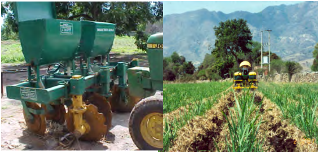
Figura 3. Equipo para fertilizar e incorporar los residuos de cosecha de la caña de azúcar.
