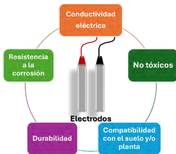
Figura 2. Características de los electrodos que garantizan su efectividad en el proceso de electroestimulación.
